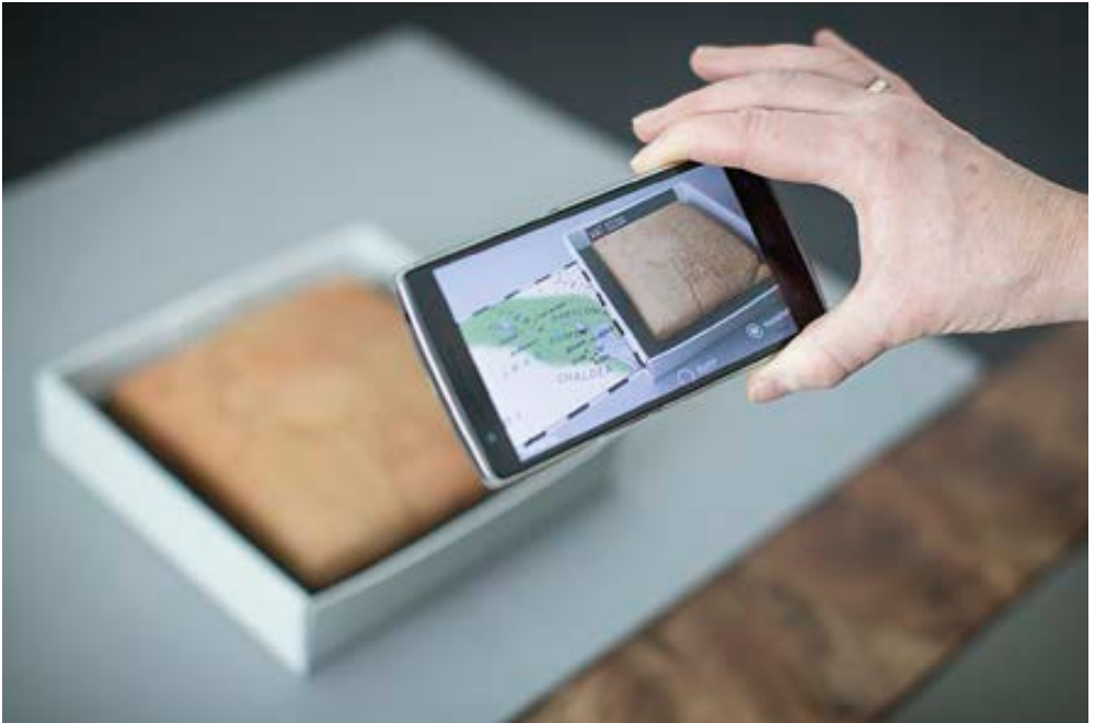
3 Im Projekt »ZEDIKUM« entwickelte Augmented Reality -App zur automatischen Erkennung von 3D-gescannten Objekten. Sie liefert Informationen zum Objekt aufs Display und findet unter anderem bei der Identifikation archäologischer Objekte Verwendung.
